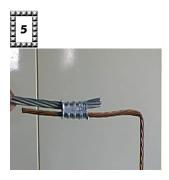
◆ Paso 5. Es recomendable comprimir desde la "L" que forma el conductor de derivación hacia fuera, para ayudar a obtener mejor contacto y fluencia, producto de la deformación del aluminio (como se muestra en la Figura 2 del ejemplo).
